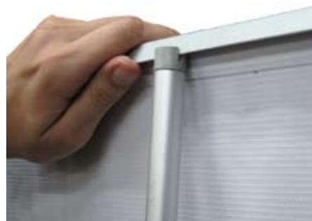
*h.* Al llegar hasta arriba, coloque un filo del soporte que sostiene a la lona en la ranura extrema del tubo. Tome en cuenta que las piezas son de aluminio, por lo que su cautelosa manipulación garantizará una mayor vida del dispositivo.
